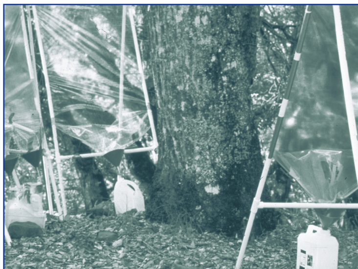
Figura 7. Colectores de agua lluvia hechos de lámina de vinilo eran estirados sobre una armadura y doblados para formar un embudo. Una jarra de un galón colocado al extremo del embudo recogió el agua lluvia.
